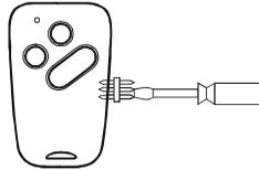
3. Halten Sie die betreffende Kanaltaste ca. 5 Sekunden gedrückt. Der Kanal wird neu codiert (Zufallsprogrammierung).
