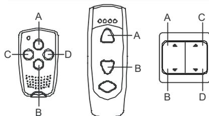
Sie können von einem Modus zum nächsten jeweils durch kurzes Drücken der Programmier-taste (< 1,6 Sekunden) wechseln: Betriebsmodus -> Programmiermodus 1 -> Programmiermodus 2 -> Betriebsmodus usw..
