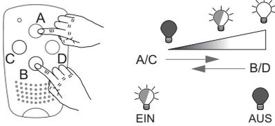
Die zuletzt genutzte Helligkeit wird beim Ausschalten gespeichert. Dimmen oder Schalten mit zwei Sendertasten (2-Tast-Bedienung).
