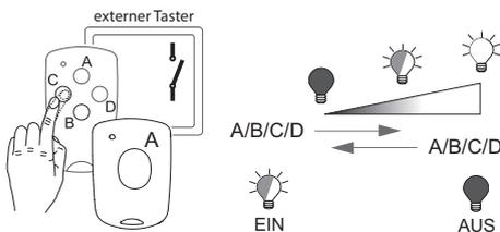
Die zuletzt genutzte Helligkeit wird beim Ausschalten gespeichert. Dimmen oder Schalten mit einer Sendertaste (1-Tast-Bedienung).
