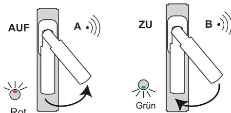
**AUS/EIN (RTS26E5001A03):** Beim Öffnen des Fensters wird der Easywave-Code B (AUS) und beim Schließen ein Easywave-Code A (EIN) gesendet.
