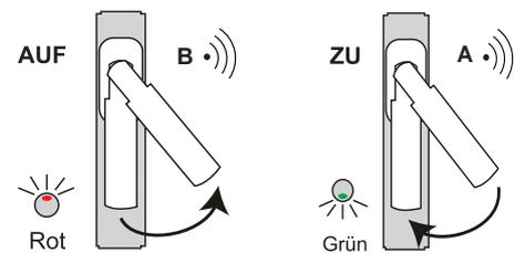
Die STATUS-Meldung ist bei beiden Varianten gleich. Ab dem letzten Sendevorgang wird mindestens 1x alle 24 Stunden der Status des RTS26 und somit der Zustand der Fenster (offen/geschlossen) gesendet. Hierfür wird einmalig das entsprechende EIN- bzw. AUS-Signal (STATUS-Signal) gesendet. Jedes Status-Signal wird aus Gründen der Übertragungssicherheit nach 10 Sekunden nochmals gesendet.
