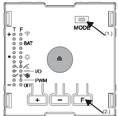
1. Abdeckung (A) entfernen und Taste **MODE** drücken. Der aktuelle Modus wird für 10s angezeigt.
